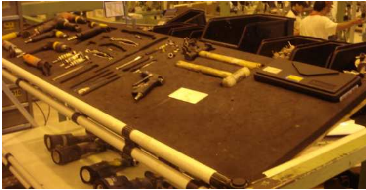
Figura 6.4- Kit de Ferramentas confeccionado para Célula Peça B
